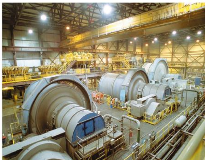
Участок дробления руды на золотоизвлекательной фабрике. Шаровые мельницы
